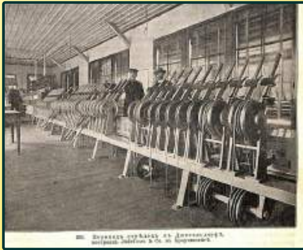
Механическая централизация стрелок и сигналов системы М.Юделя. Дюссельдорф. Из книги: «Промышленность и техника», т. IX, С.-Петербург, 1909 г.
